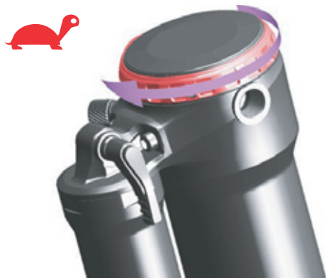
Obr. 108: Otočení tlumiče zpětného odskoku směrem k želvě
