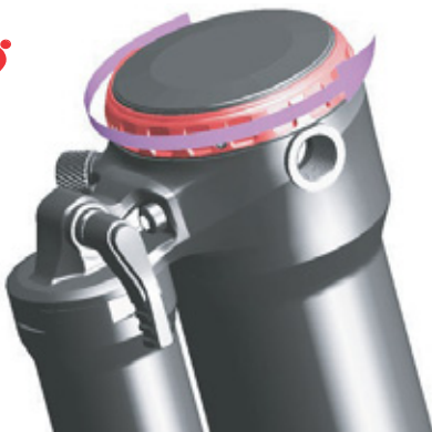
Obr. 110: Otáčení tlumiče zpětného odskoku směrem k zajíci
