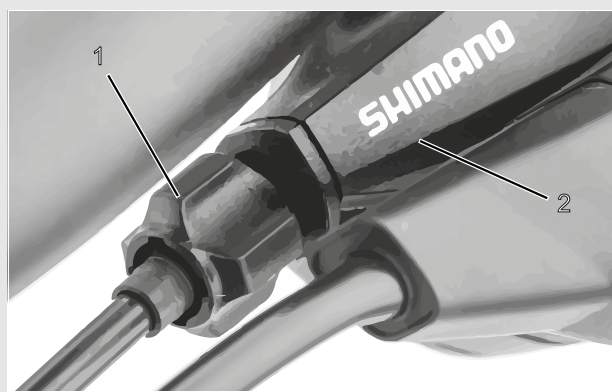
Obr. 96: Seřizovací pouzdro (1) řazení převodů ovládané jedním lankem s řadicí páčkou (2), příklad
