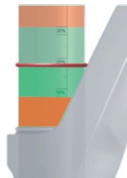
Obr. 55: Předepsaný rozsah SAG (zelený) a zakázaný rozsah SAG
