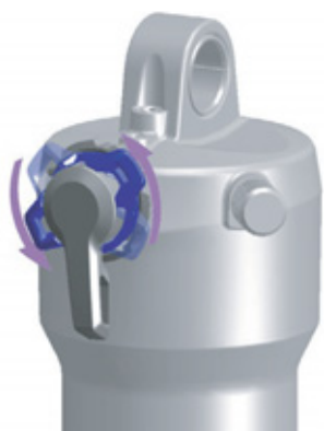
Obr. 114: Měkké nastavení nastavovacího šroubu komprese
