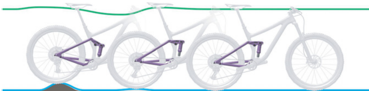
Obr. 107: Příliš rychlé roztahování tlumiče zadního odpružení
