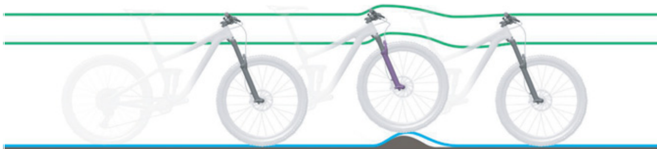
Obr. 105: Příliš tvrdé tlumení odpružené vidlice u nerovností
