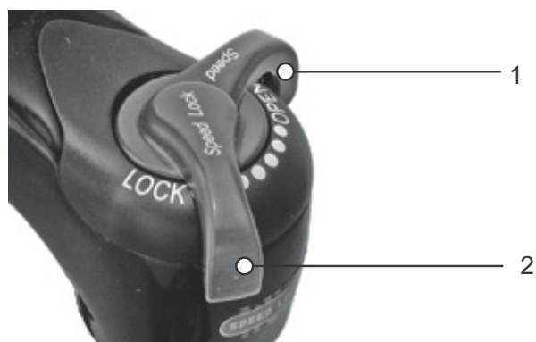
Obr. 88: Tlumič komprese Suntour v otevřené (1) a zavřené (2) poloze
