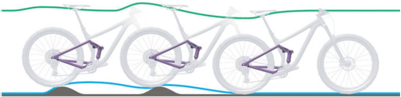
Obr. 109: Příliš pomalé roztahování tlumiče zadního odpružení
