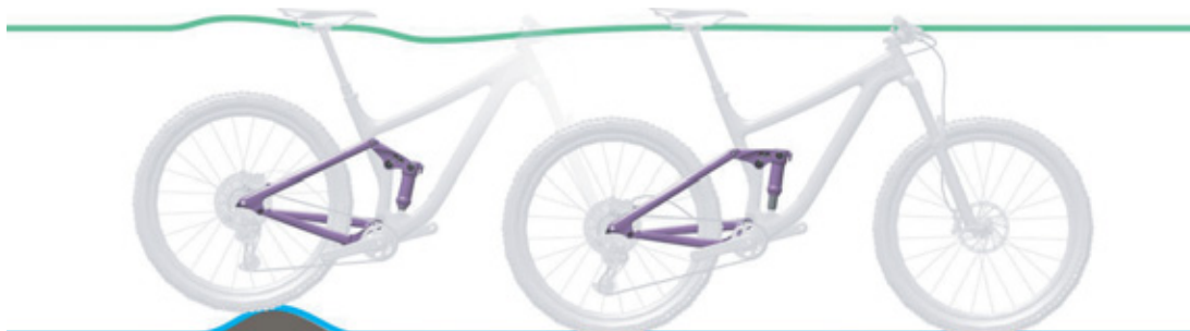
Obr. 12: Optimální chování tlumiče zadního odpružení při jízdě u nerovností
