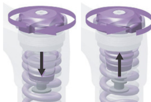
Obr. 52: Otáčení nastavovacím kroužkem předpětí dovnitř a ven
