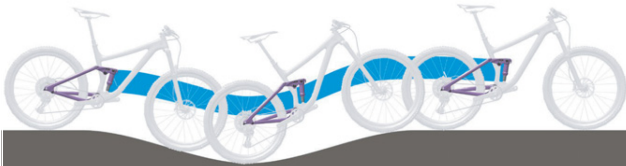
Obr. 63: Optimální chování tlumiče zadního odpružení při jízdě v kopcovitém terénu
