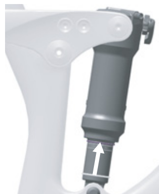
Obr. 57: Posunutí O-kroužku na tlumiči zadního odpružení
