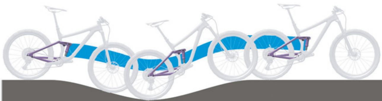
Obr. 11: Optimální chování tlumiče zadního odpružení při jízdě v kopcovitém terénu
