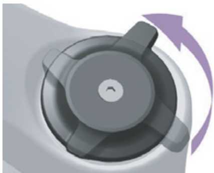
Obr. 90: Měkké nastavení nastavovacího šroubu komprese
