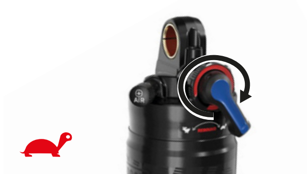
Obr. 61: Snížení rychlosti roztahování
