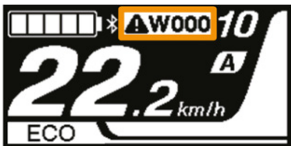
Obr. 43: Příklad varovného pokynu W000
