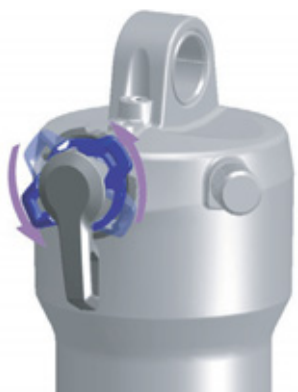
Obr. 66: Měkké nastavení nastavovacího šroubu komprese
